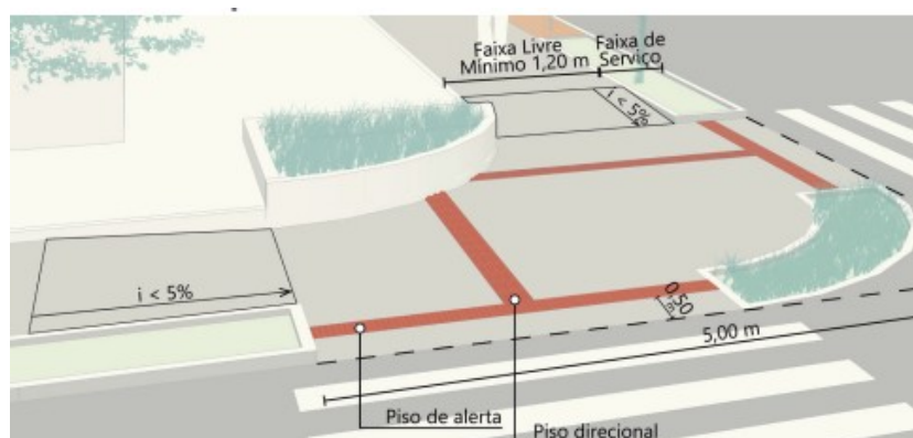
Figura 9: Rampas e rebaixamento da esquina Fonte: MACEIÓ
