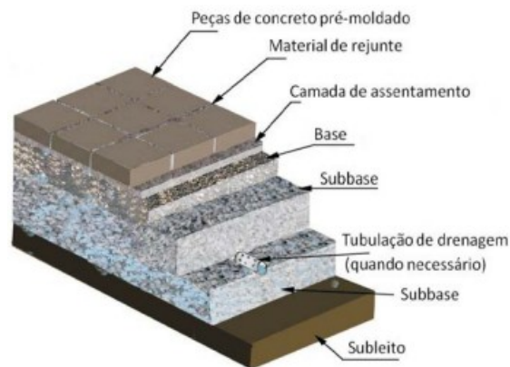
Figura 3 – Seção típica pavimento intertravado permeável
