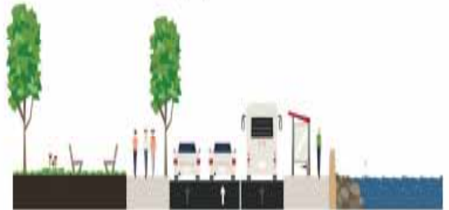
Figura 41: Seção de Av. Beira-Rio - Trecho 4 com faixa prioritária para ônibus e ponto de ônibus Fonte: Produção Logit - www.streetmix.net
