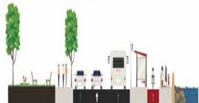
Figura 42: Seção de Av. Beira-Rio - Trecho 4 com faixa prioritária para ônibus, ponto de ônibus e ciclovia Fonte: Produção SEMDURB - www.streetmix.net
