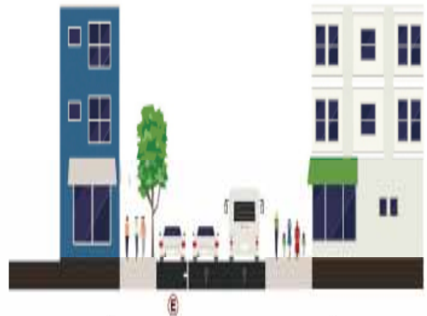
Figura 66: Seção da Rua Bernardo Horta - Trecho 3 com estacionamento à esquerda Fonte: Produção Logit - www.streetmix.net
