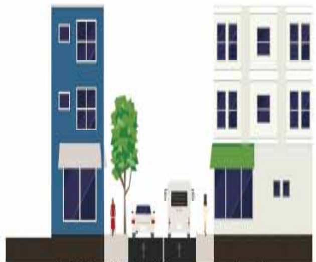
Figura 47: Seção do via de Rua Siqueira Lima com faixa preferencial para ônibus Fonte: Produção SEMDURB - www.streetmix.net
