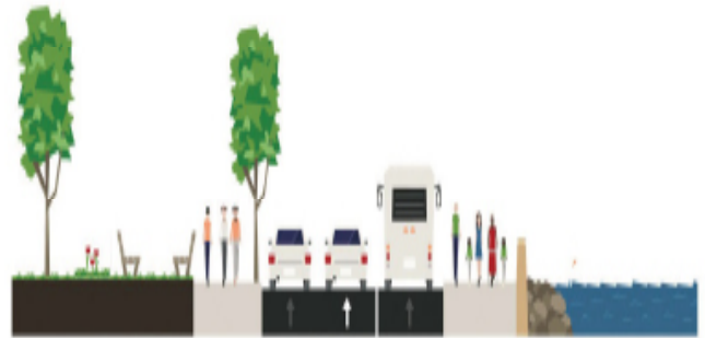
Figura 40: Seção de Av. Beira-Rio - Trecho 4 com faixa prioritária para ônibus Fonte: Produção Logit - www.streetmix.net
