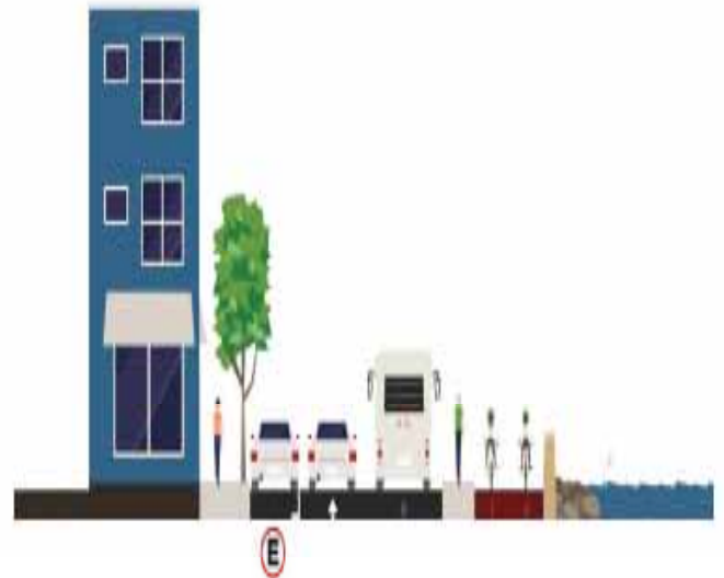
Figura 38: Seção da Av. Beira-Rio - Trecho 3 com ciclovia à direita dos pedestres e área para embarque e desembarque. Fonte: Produção Logit - www.streetmix.net
